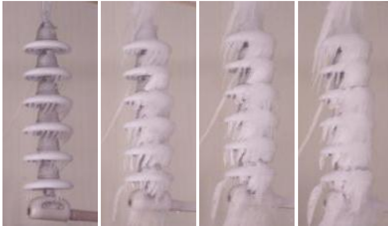
Figure 18 : Accumulation de la glace après 20, 55, 85 et 115 minutes
