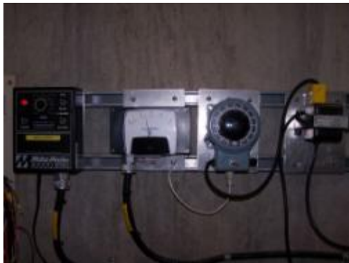
Figure 13 : Système de chauffage et d'oscillation
