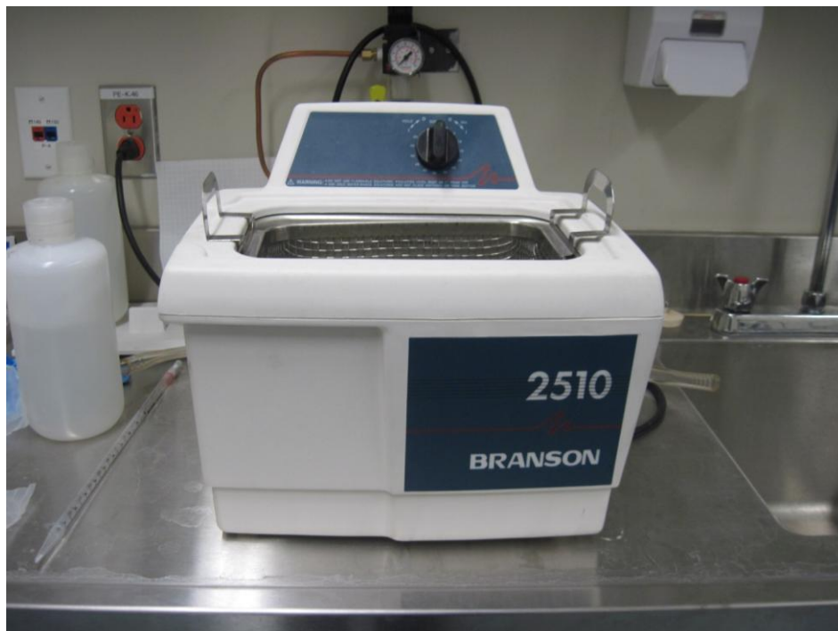
Figure 27: Bain ultrasonique pour le nettoyage
