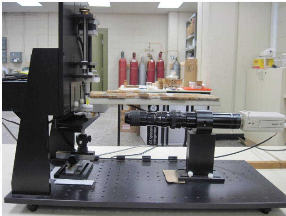
Figure 34: Appareil de mesure d'angle de contact appartenant à la chaire de recherche GRTB
