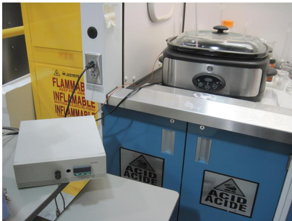
Figure 28: Bain-marie servant à l'attaque chimique
