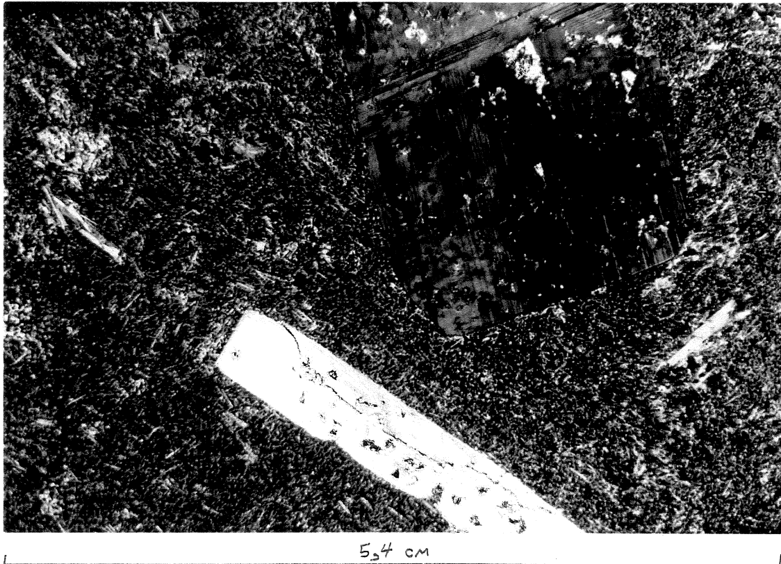
Planche 3.8: Photomicrographie en lumière polarisée de l'échantillon F. Phénocristaux de plagioclase violacé idiomorphes de la phase aphanitique, composé de micro-plagioclases en bâtonnet, de chlorites et d'opaques (2.5X).
