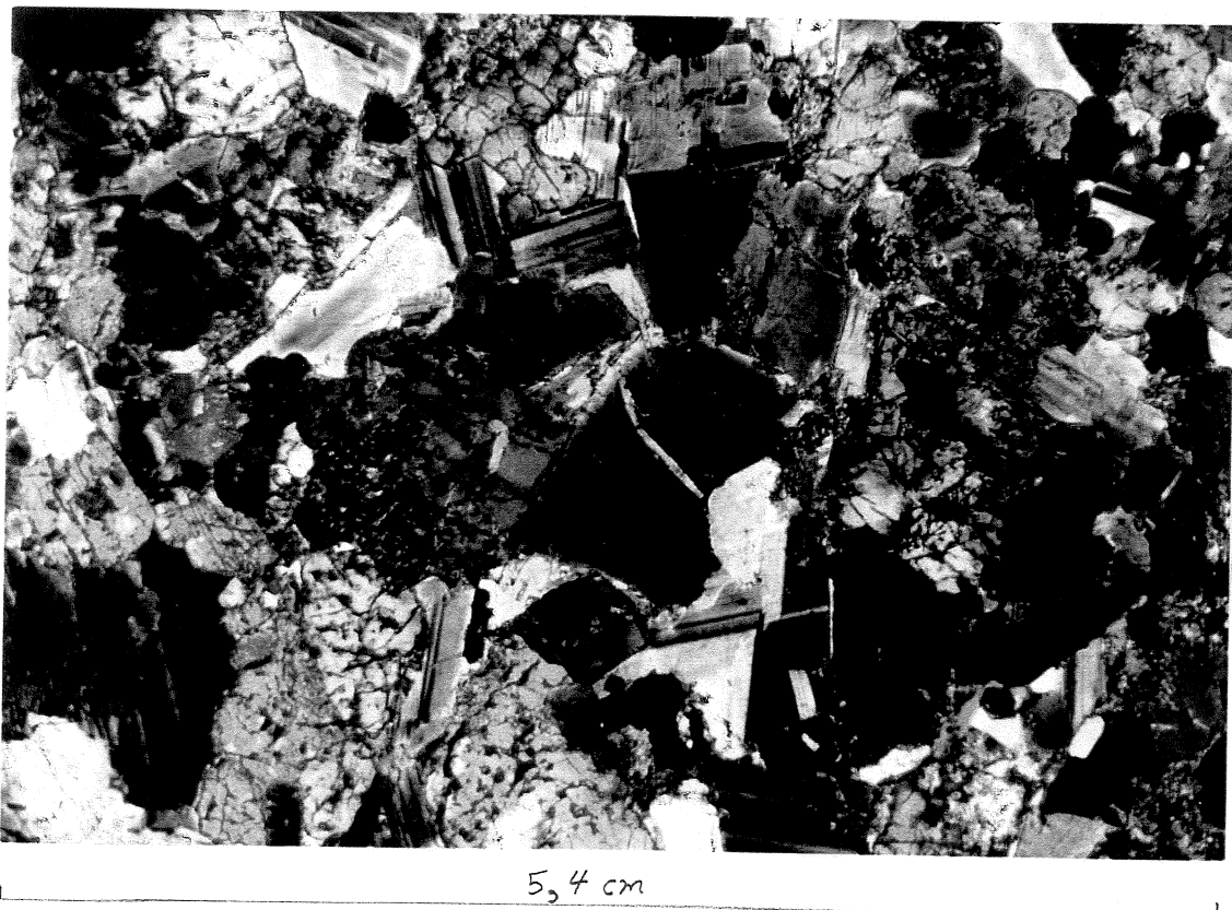
Planche 3.4: Photomicrographie en lumière polarisée de l'échantillon D. Leucogabbronorite de la phase minéralisée à plagioclase très violacé et non recristallisé (2.5X).
