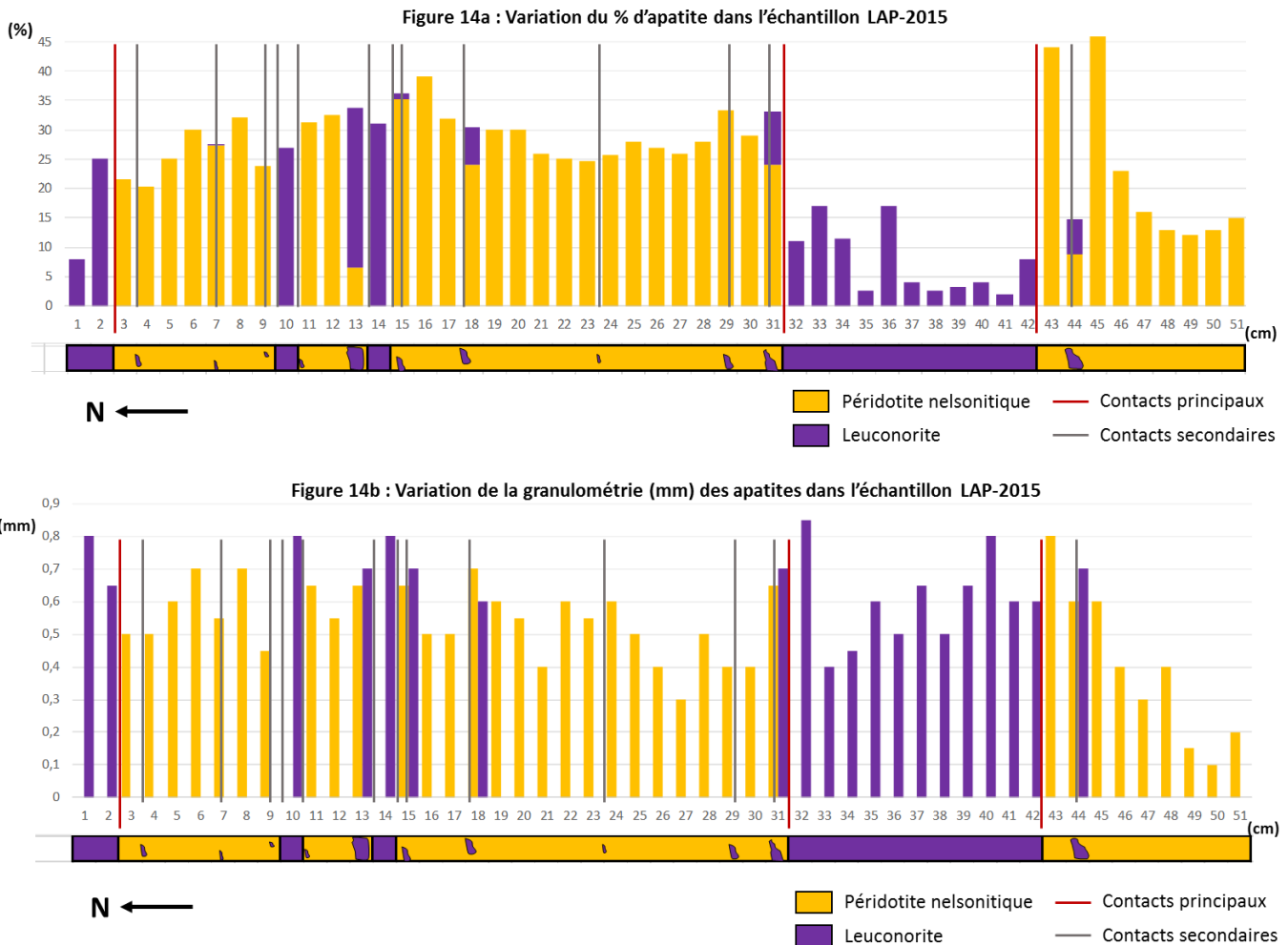
Figure 14 : Diagrammes à bandes décrivant la distribution et la granulométrie des apatites dans l'échantillon LAP-2015
