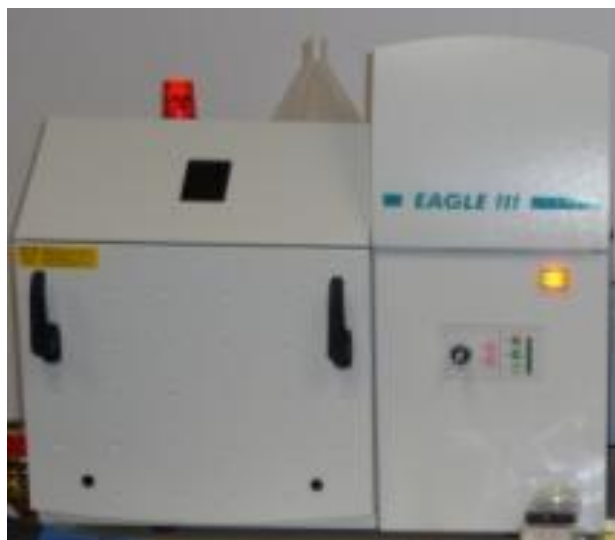
Figure 3.4 – La microfluorescence-X est une méthode non destructrice qui permet d'analyser les éléments majeurs des grains en utilisant un faisceau de 50 \mu\text{m} . L'appareil utilisé se nomme Micro-XRF EDAX Eagle III.
