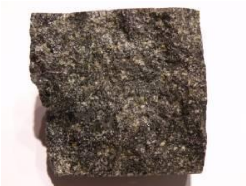
Figure 3.2 - Carotte de forage cassée en deux ayant servi à faire la lame mince polie 9275-80. Troctolite homogène à texture équigranulaire, de couleur noire verdâtre en cassure fraîche, magnétique, composée essentiellement de magnétite, d'ilménite, d'apatite et d'olivine.
