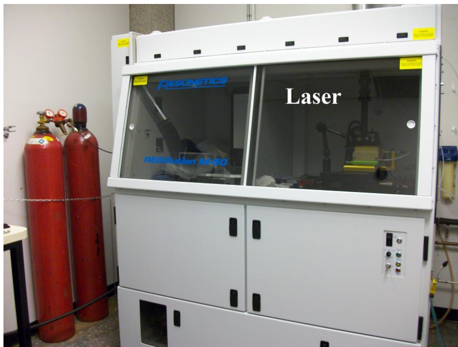
Figure 3.6 – Système d'ablation par laser. L'ablation par laser permet d'analyser du matériel solide en dirigeant la matière vaporisée vers le spectromètre de masse afin d'en analyser la composition.
