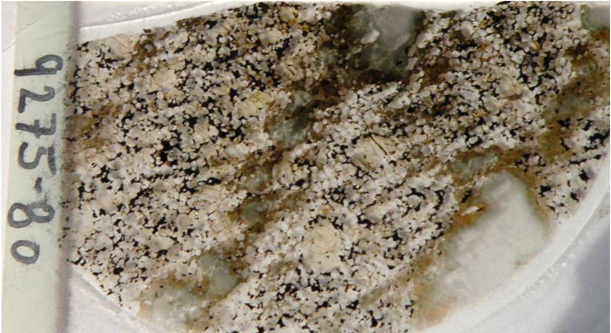
Figure 3.16 -Photo de la lame 9275-80. On y observe des phénocristaux de plagioclase et d'olivines. Les minéraux interstitiels noirs sont les oxydes. Les figures 3.17 et 3.18 sont des cartographies des éléments majeurs provenant toutes de cette lame mince analysée à la microfluorescence-X.
