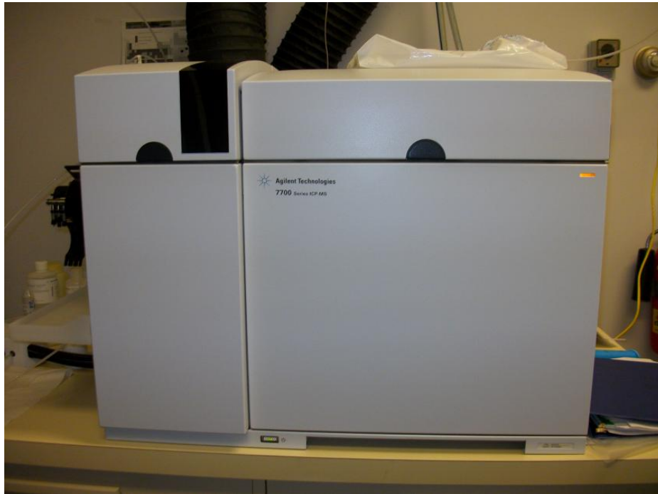
Figure 3.5 – Spectromètre de masse à émission de plasma. Cette technique d'analyse possède des limites de détection très basses et permet le dosage d'un large spectre d'éléments mineurs et sous la forme de trace.
