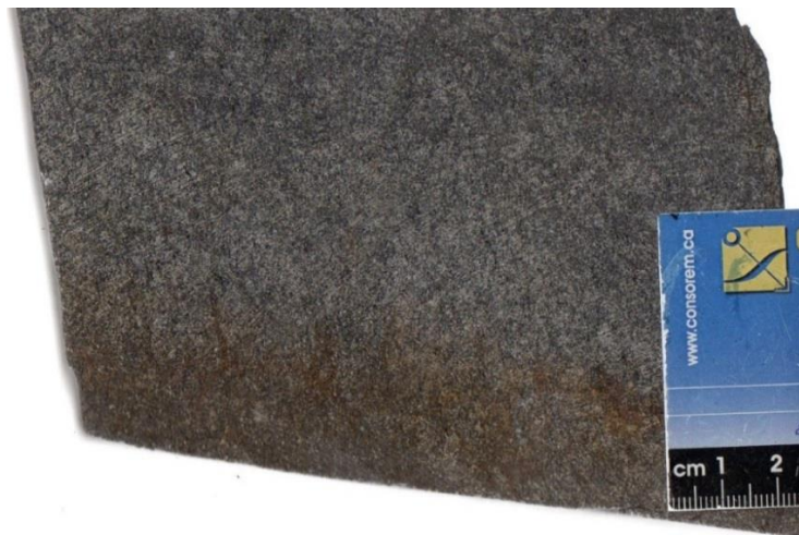
Figure 8: Photo mégascopique (Méga-04) : Orthopyroxénite avec une granulométrie fine ( \leq 1,0 mm). Provient de la rainure 2 (R2) (annexe 2).
