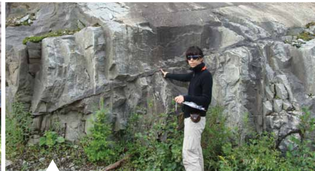
L'étudiante Daphné PINO indiquant une fracture favorisant l'écoulement des eaux souterraines dans le massif rocheux.
